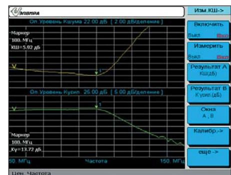
Рис. 14. Интерфейс программного обеспечения для измерения КШ в «СК4-БЕЛАН 32»
