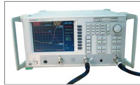
Рис. 11. Измерение коэффициента шума на векторном анализаторе цепей Anritsu MS423B с опцией 04
